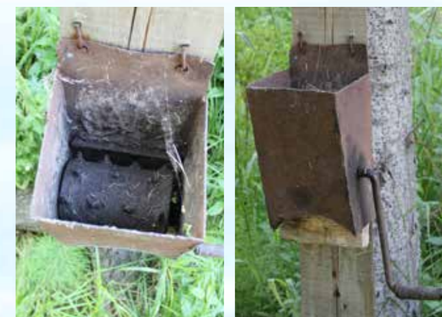
Шишкорушка - приспособление для извлечения кедровых орехов из шишек
